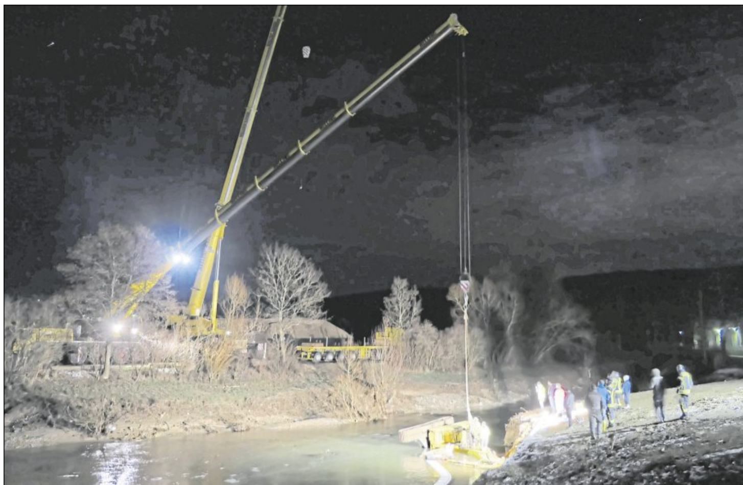
Der Versuch in der Nacht, den Bagger wenigstens wieder auf die Raupen zu stellen. Ein zähes Unterfangen, weil sich auf die Schnelle keine Schwerlastöse am hinteren Teil des Baggers anbringen ließ. Foto: Beytekin
